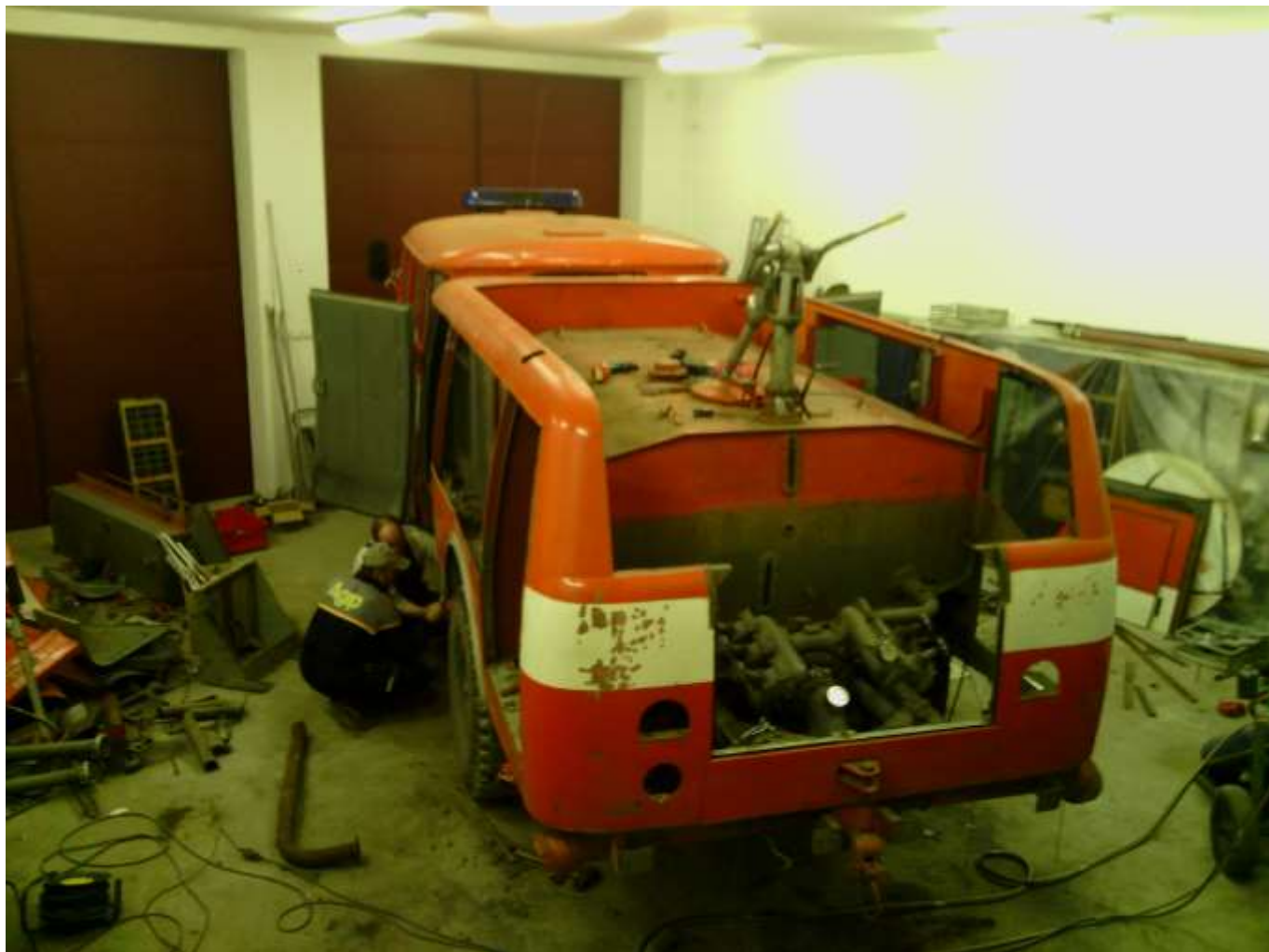
Rozřezaný plášť nástavby: foto Vl. Prágr
